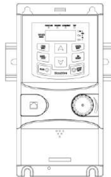
نصب روی ریل
